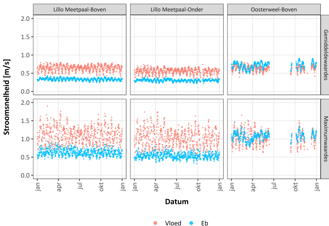
Figuur 28 – Verloop van de stroomsnelheid in 2020 tijdens vloed en eb voor de verschillende meetstations.
