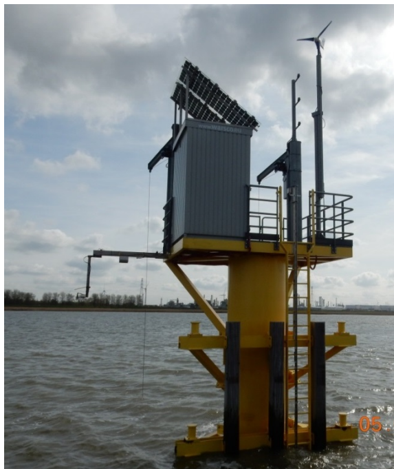
Figuur 72 – Locatie Lillo-Meetpaal met links-uitstekend arm van golvenmeter (links) en detail Log-aLevel toestel (rechts)
